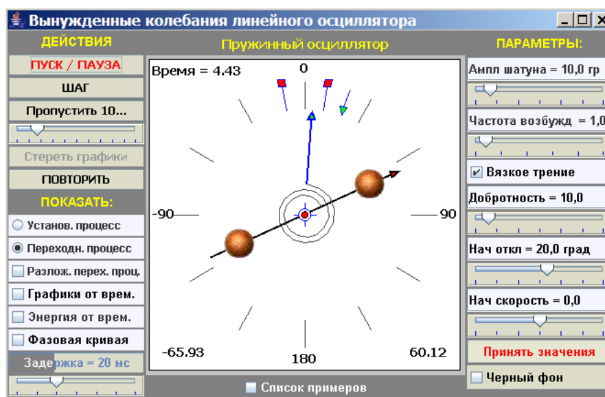
Рис. 1: Торсионный пружинный осциллятор, возбуждаемый заданным периодическим движением шатуна, к которому прикреплена спиральная пружина.
