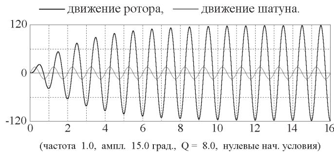
Рис. 4.5: Переходный процесс при резонансе (графики угла отклонения для возбуждающего шатуна и маховика осциллятора при нулевых начальных условиях).
