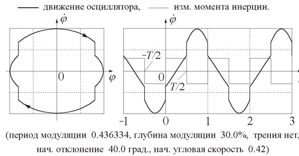
Рис. 6.5: Стационарные параметрические колебания на нижней границе основного интервала неустойчивости (вблизи T = T_{av}/2 ).
