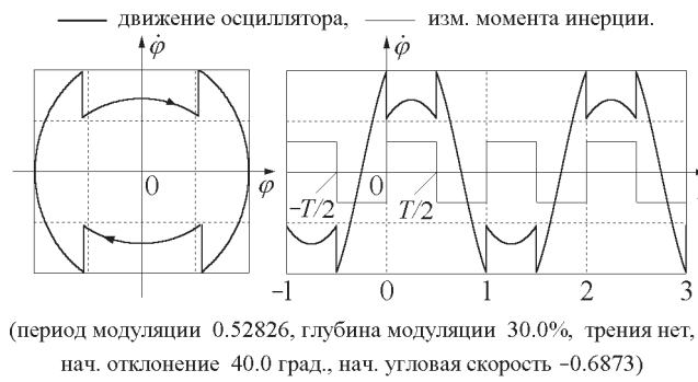
Рис. 6.6: Стационарные параметрические колебания на верхней границе основного интервала неустойчивости (вблизи T = T_{av}/2 ).
