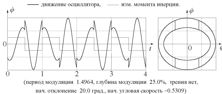
Рис. 6.7: Стационарные параметрические колебания на границе интервала неустойчивости вблизи T = 3T_{av}/2 .
