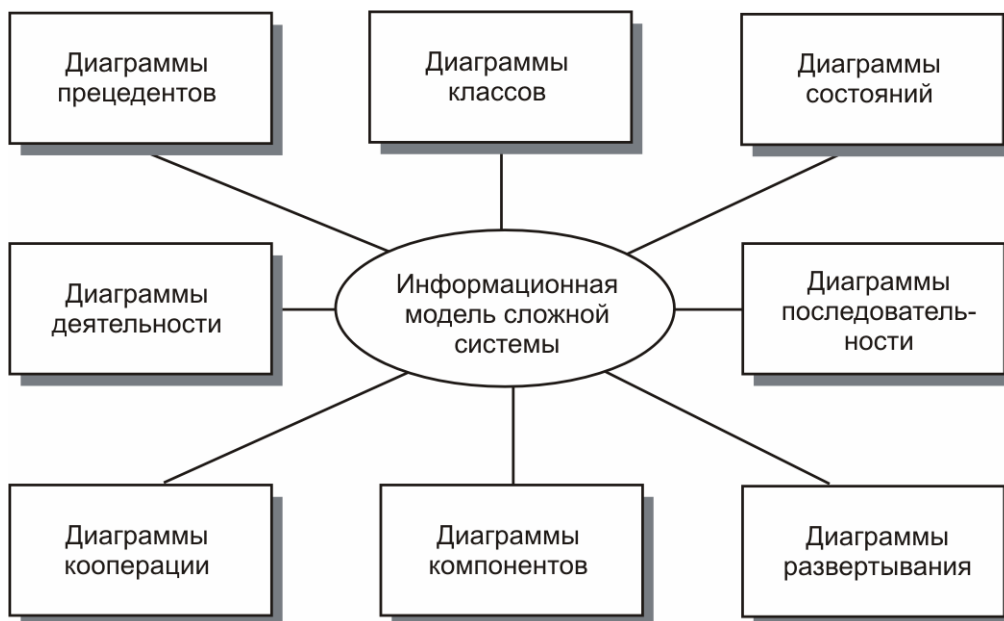
Рис. 1.6. Интегрированная модель сложной системы в нотации UML
